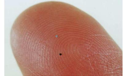
$\mu$ Controller von Sand-/Staubkorngröße, die über Radiofrequenztechnik miteinander kommunizieren [2]:
