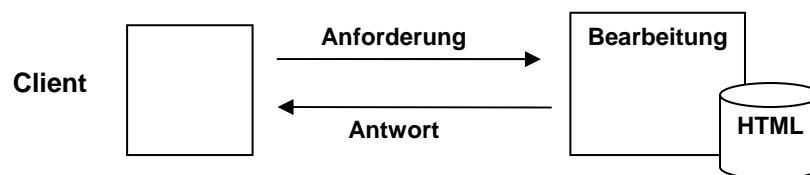
Abbildung 1: Kommunikationsschema für statische Webseiten
